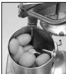
Afin d'obtenir un résultat de coupe optimale lors de la réalisation de frites, il est indispensable d'utiliser la **paroi amovible** et d'alimenter la partie gauche de la goulotte (voir photo ci-contre).
