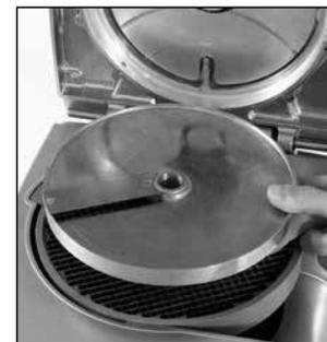
Ensuite, emboîter le disque éminceur correspondant (disque lame droite) et le faire pivoter dans le sens des aiguilles d'une montre pour s'assurer qu'il est correctement positionné.
