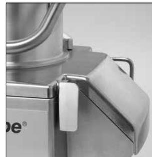
Soulever la tête du coupe-légumes de façon à la faire basculer en arrière pour dégager la cuve et dévisser le cône de chargement ou l'évideur. Pour l'évideur, se servir de l'outil de démontage prévu à cet effet.
