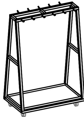
Structure en tube carré section 40 mm inox 1.4307
