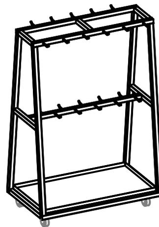
Structure en tube carré section 40 mm inox 1.4307
