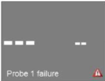
Faulty sensor alarm : un capteur endommagé ou une connexion incorrecte du capteur est représenté par une icône d'alarme et le message d'alarme est disponible sur la ligne inférieure.
