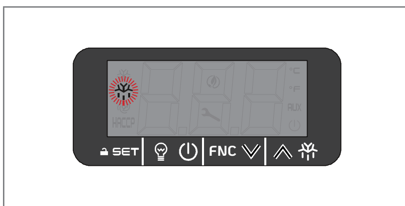
Fig 3.17 - Icône de dégivrage clignotante
