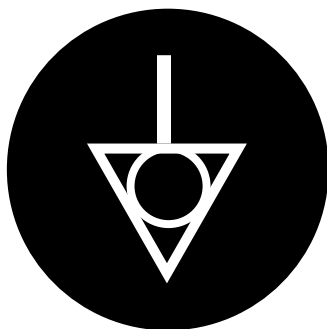
Mise à terre réseau
