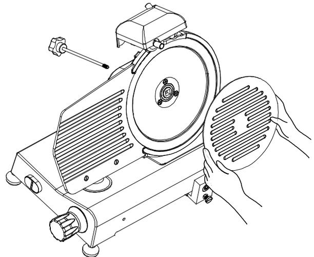
FIG. n°4 – Démontage du protecteur de lame
