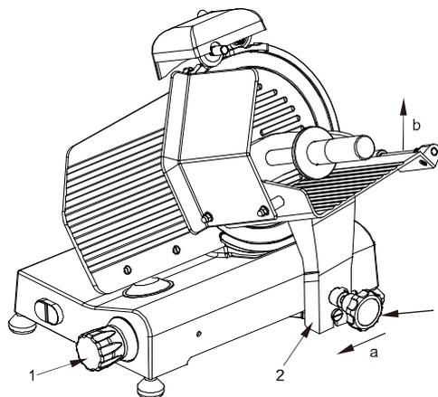
FIG. n°3 – Démontage du chariot.
