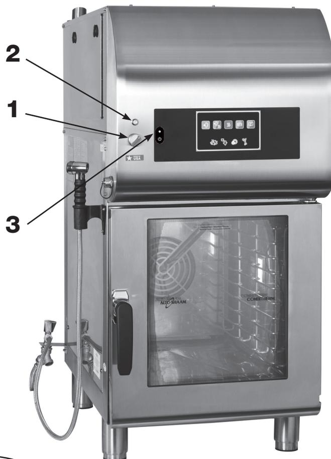
**Mécanisme de verrouillage temporisé :** Pour permettre d'évacuer l'air chargé de vapeur et de graisse de l'intérieur du four, ce mécanisme empêche d'ouvrir complètement la porte du four pendant 20 secondes. Il est possible de programmer des délais d'attente plus longs dans la commande. Ce mécanisme se débraye automatiquement à l'expiration d'une durée fixée pour permettre l'ouverture complète de la porte.
