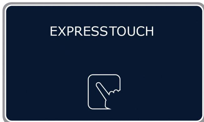
Lorsque le four est mis sous tension, l'écran ExpressTouch s'allume. Le message « Loading » indique que le logiciel est en cours de démarrage. L'écran indique aussi le degré de progression jusqu'à ce que le logiciel soit pleinement opérationnel.
