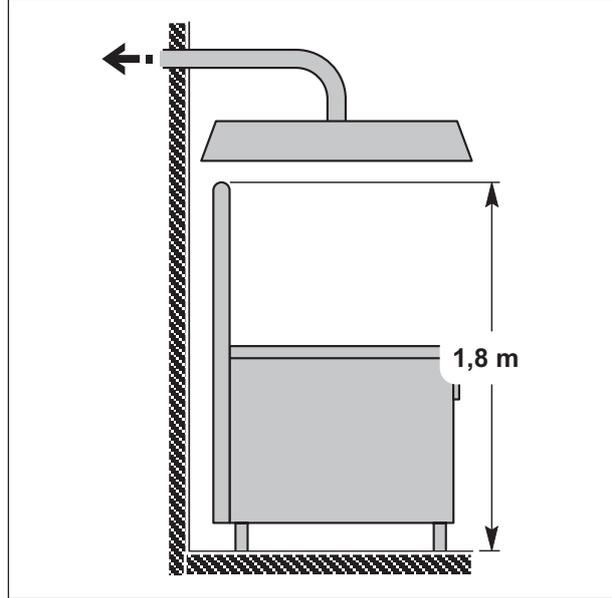
Fig. 22 Échappement à travers une hotte
