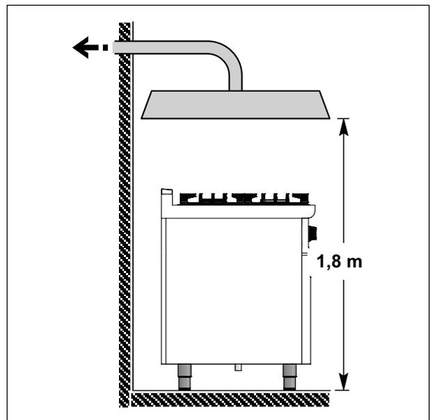
Fig. 28 Évacuation des fumées à travers la hotte aspirante
