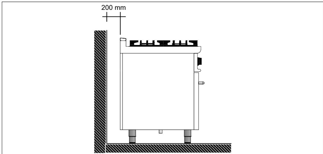
Fig. 25 Distance minimum de parois inflammables
