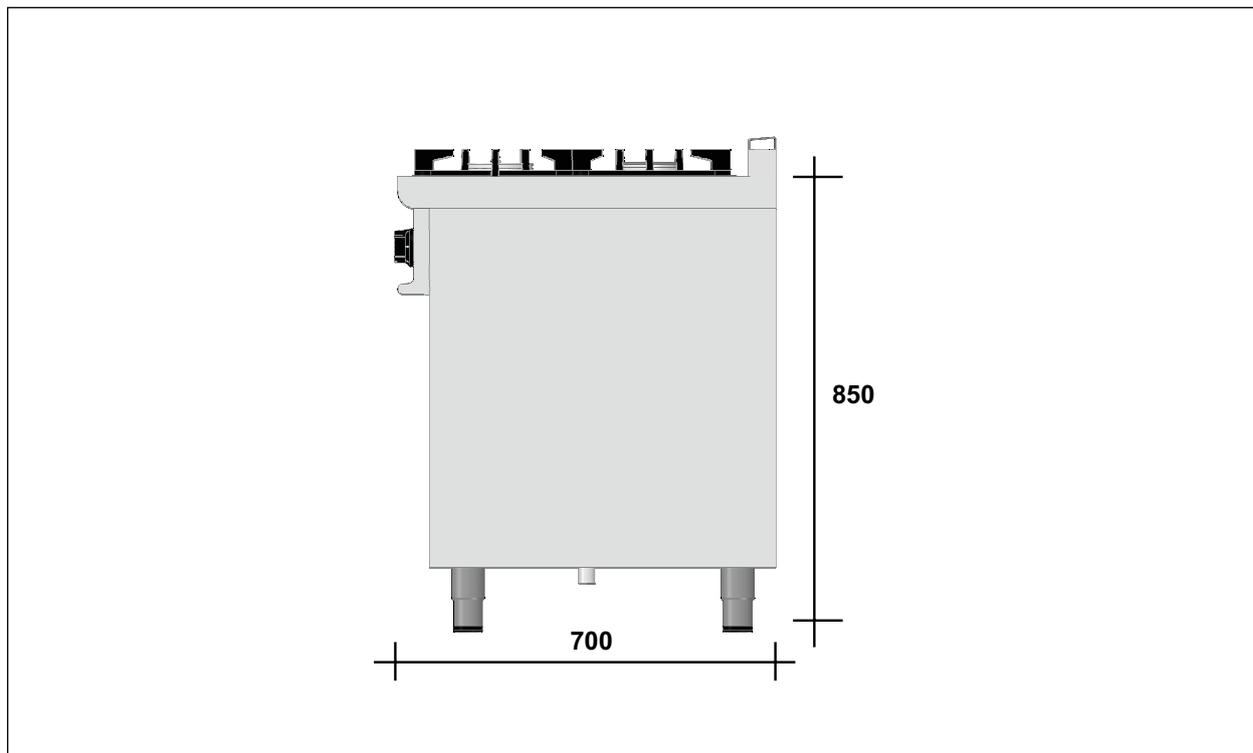
Fig. 14 Dimensions cuisinière avec soubassement ouvert ou fermé
