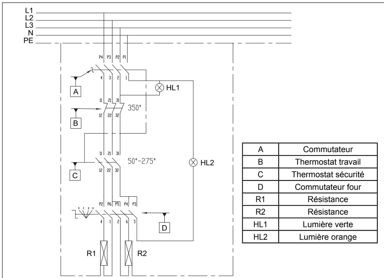
Fig. 35 Schéma électrique 1 - Four électrique
