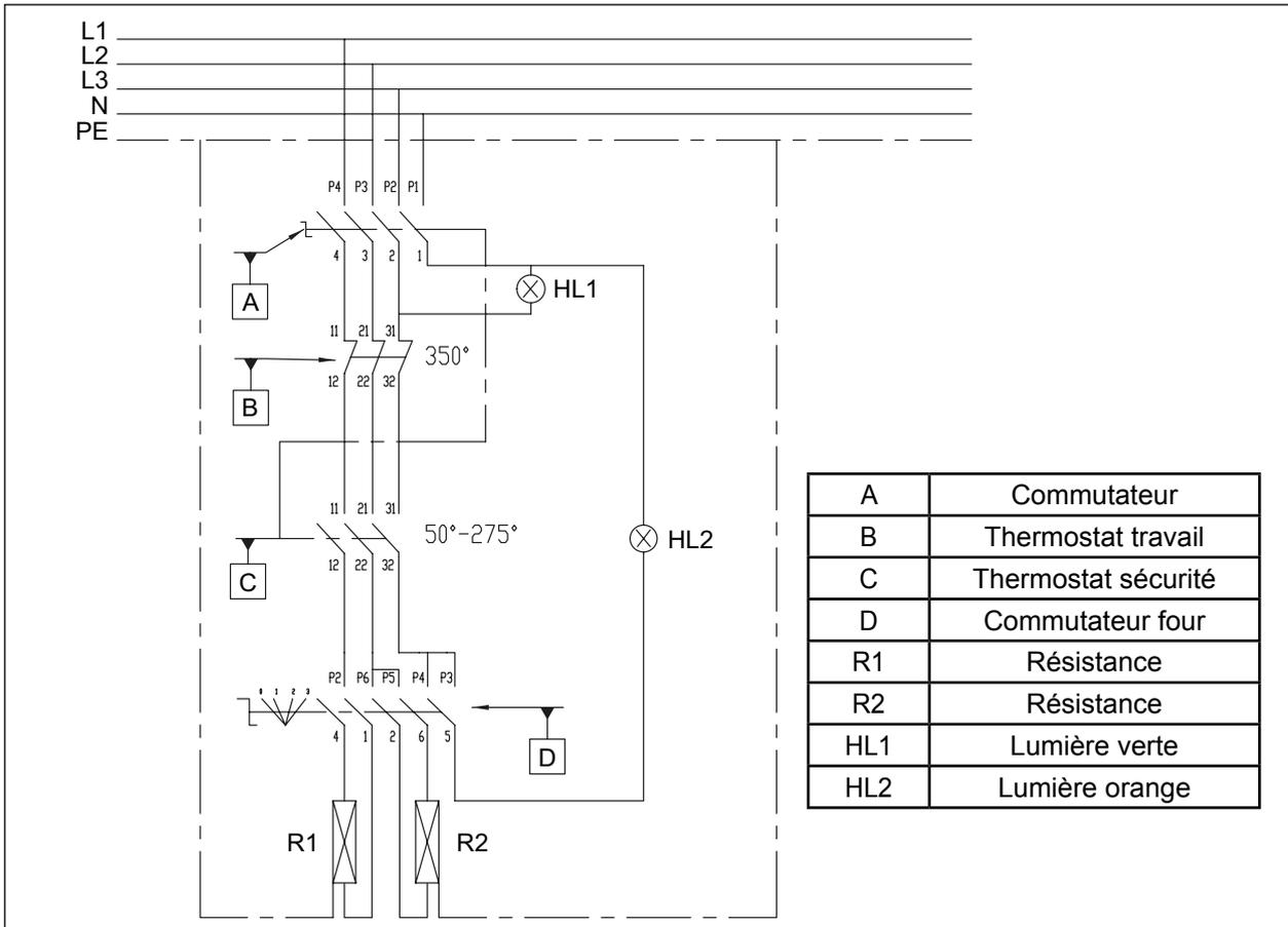
Fig. 35 Schéma électrique 1 - Four électrique
