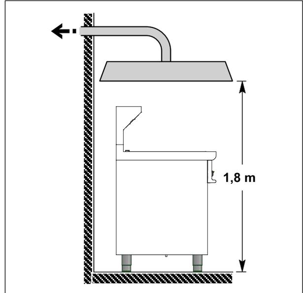
Fig. 17 Échappement à travers une hotte
