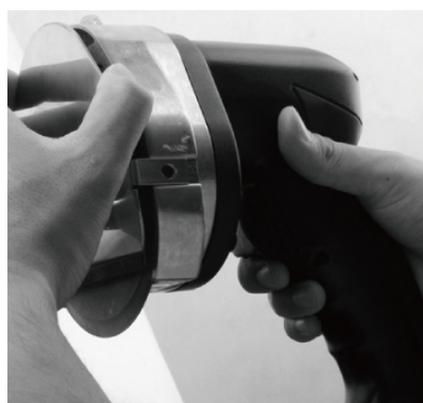
Attacher le protecteur de lame et verrouiller la vis.
