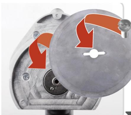
Insérer la nouvelle lame en vissant sur le disque, puis fixer la vis.
