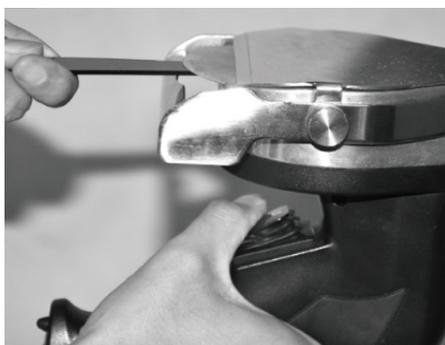
Aiguiser le couteau circulaire sans dents pendant environ 1 à 2 secondes à un angle très plat par le côté inférieur.
