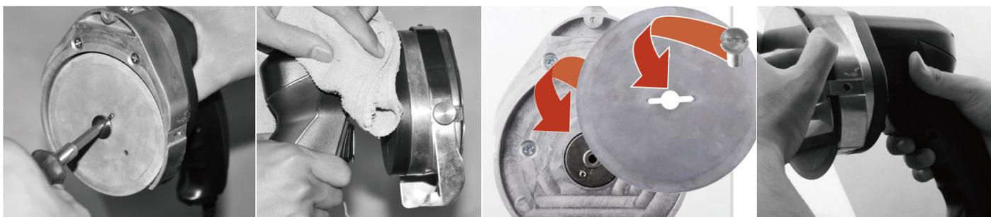
7. Attacher le protecteur de lame et verrouiller la vis.
