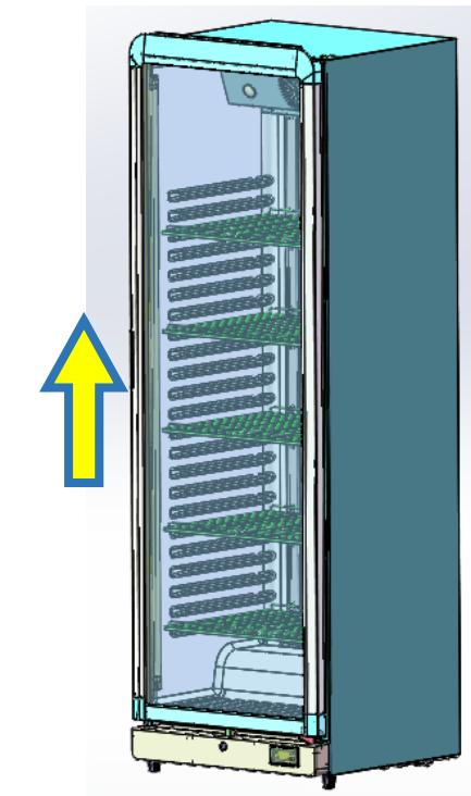
1.3 Soulever la porte verticalement de 20 mm et la mettre de côté pour les étapes suivantes. Prendre les précautions adaptées pour éviter toute blessure et tout dégât.
