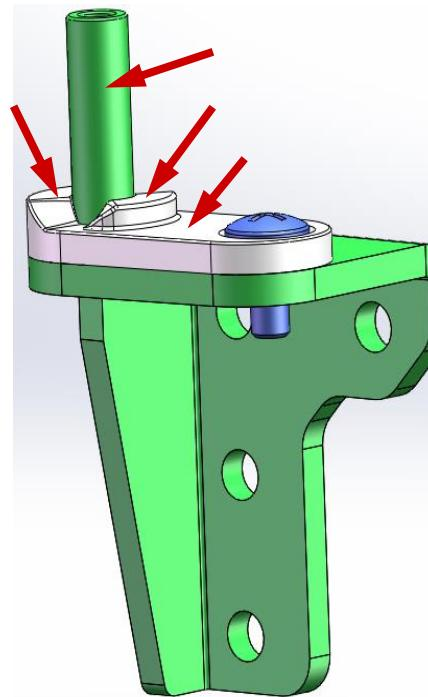
3.3 Appliquer du lubrifiant sur l'axe de la charnière et les surfaces marquées de la nouvelle charnière fournie dans le kit.
