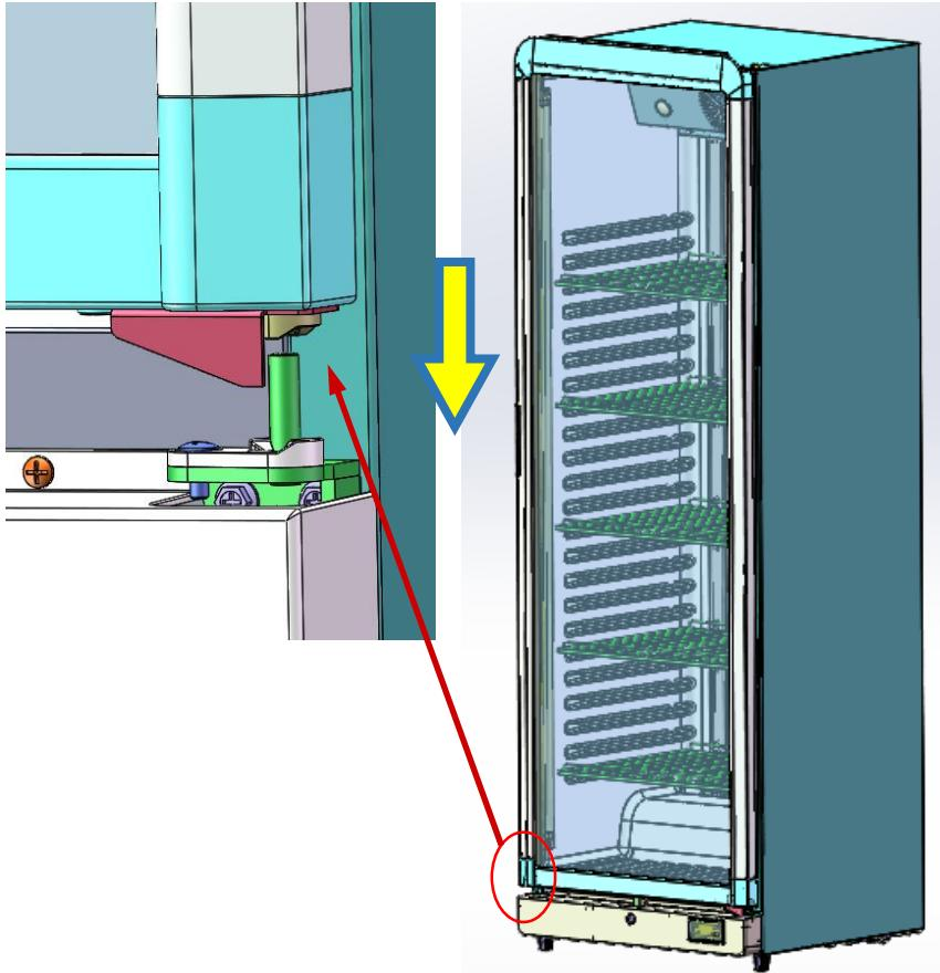
4.1 Présenter la porte 30mm au dessus de sa position finale puis l'abaisser jusqu'à ce que l'arbre de la charnière inférieure s'engage complètement dans la douille. Prendre les précautions adaptées pour éviter toute blessure et tout dégât.
