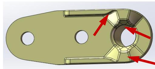
2.3 Appliquer du lubrifiant sur le trou, les zones marquées et la douille d'arbre fournie dans le kit.
