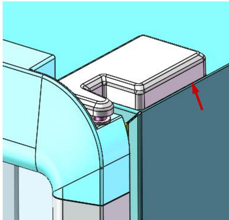
1.1 Utiliser un outil à tête plate tel qu'un tournevis pour faire levier sur le bord du couvercle de la charnière supérieure et libérer les clips. Retirer le couvercle de la charnière supérieure.
