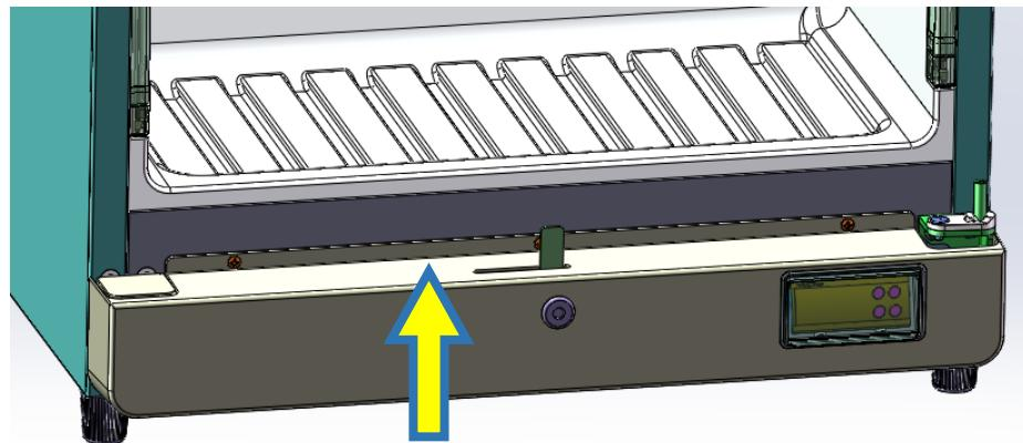
3.1 Désserer les 3 vis du bandeau avant puis le soulever de 10mm pour le retirer. Prendre les précautions adaptées pour éviter toute blessure et tout dégât.
