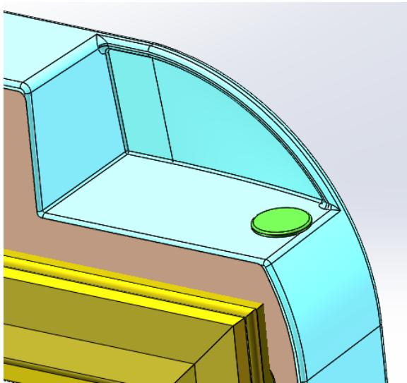
2.1 Sur la porte, retirer les bouchons des trous et les bagues des deux côtés, puis les intervertir et les réinstaller (c'est-à-dire intervertir les positions d'installation supérieures gauche et droite).
