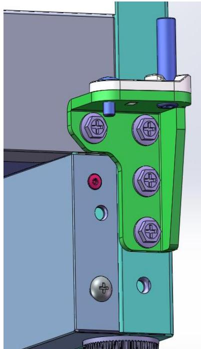
3.2 Retirer les 4 vis pour detacher et retirer la charnière inférieure droite.
