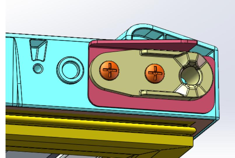
2.2 Au niveau du coin inférieur droit, desserrer les vis pour retirer la butée droite et la douille de l'arbre.
