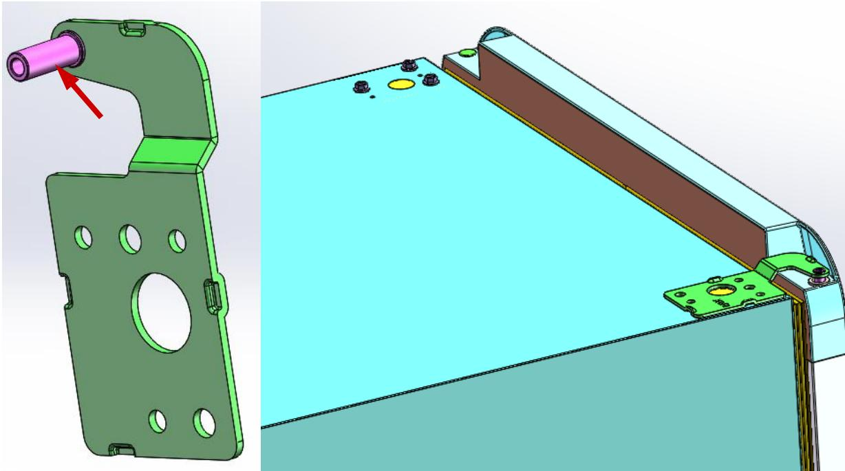
4.2 Appliquer du lubrifiant sur l'arbre de la charnière supérieure puis installer la en insérant l'arbre de la charnière dans la douille de porte supérieure gauche. Visser la charnière puis cacher les trous d'origine à droite.
