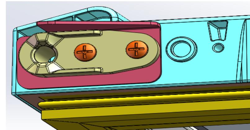
2.4 Installer l'ensemble dans le coin inférieur gauche. Veiller à la symétrie avec l'assemblage d'origine.
