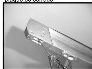
*Tirez fermement au moyen d'une pince et d'un étau et vissez les résistances dans la plaque de serrage.*
