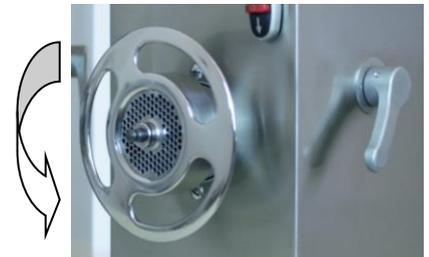
Si la machine est trifasé et l'helice travaille dans le sense horaire, faire inverse les deux fils dans la prise de part du Service Apres Vente.
