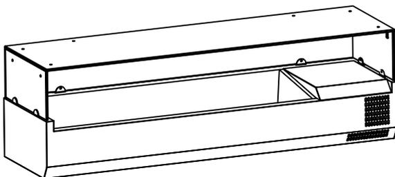
**4/ Placez les rondelles en caoutchouc à l'intérieur des trous de la vitre supérieure, puis fixez la sur les vitres en place.**
